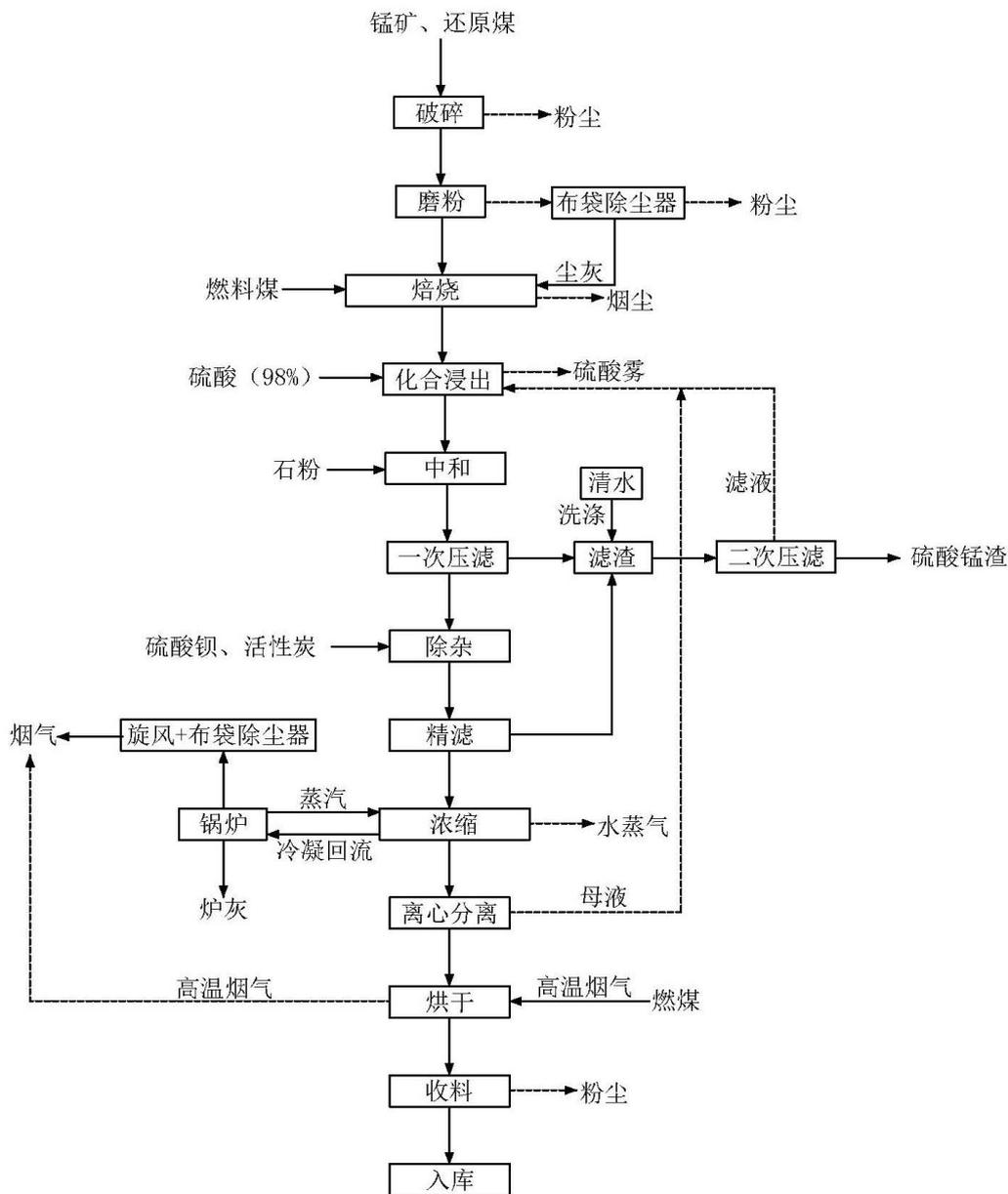
图 2.1-1 原有项目工艺流程图
