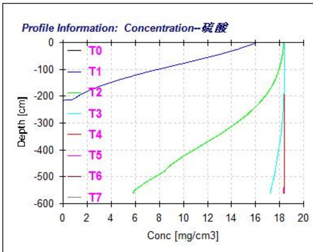
图 4.7-3 SO<sub>4</sub><sup>2-</sup>在不同深度的最大浓度图
