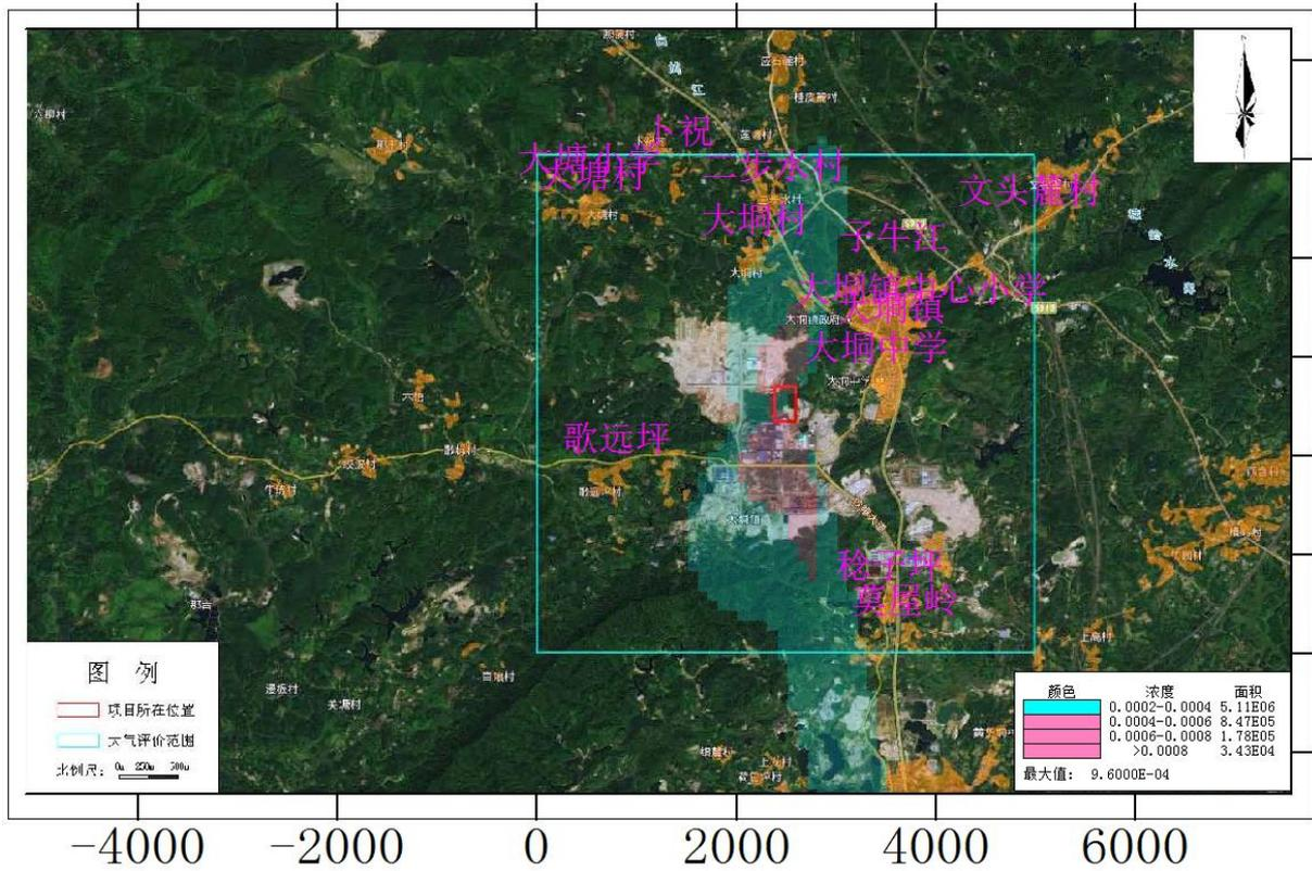
图 4.2-12 TSP 日平均质量浓度贡献值分布图 (单位  $\mu\text{g}/\text{m}^3$ )
