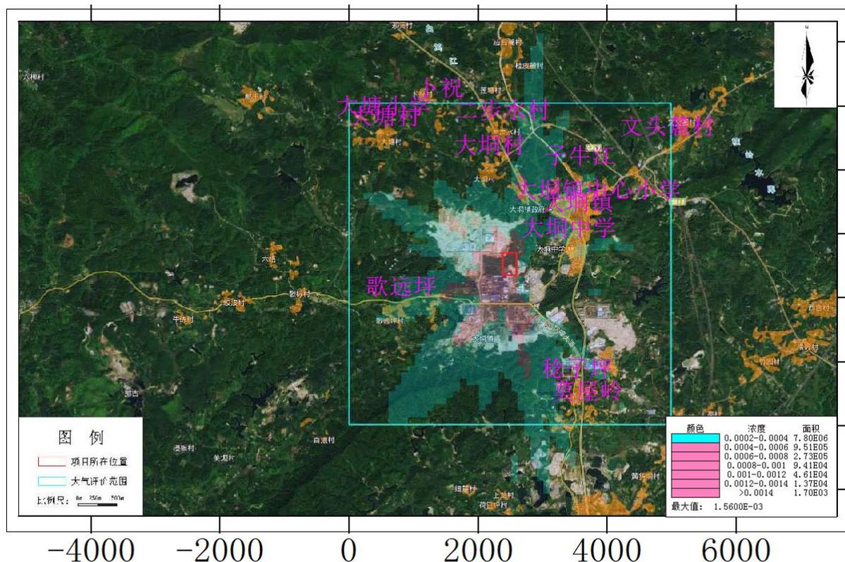
图 4.2-18 硫酸雾小时平均质量浓度贡献值分布图 (单位  $\mu\text{g}/\text{m}^3$ )
