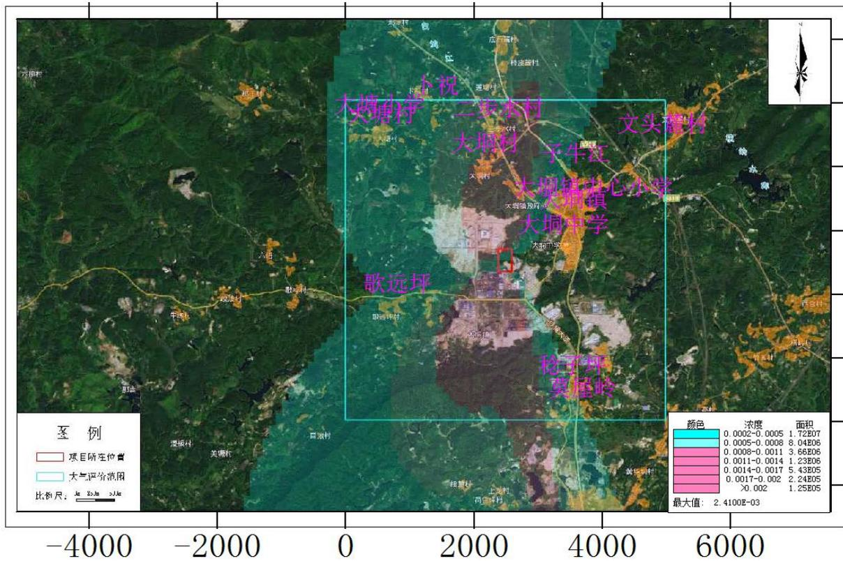
图 4.2-9 NO<sub>2</sub> 小时平均质量浓度贡献值分布图（单位  $\mu\text{g}/\text{m}^3$ ）
