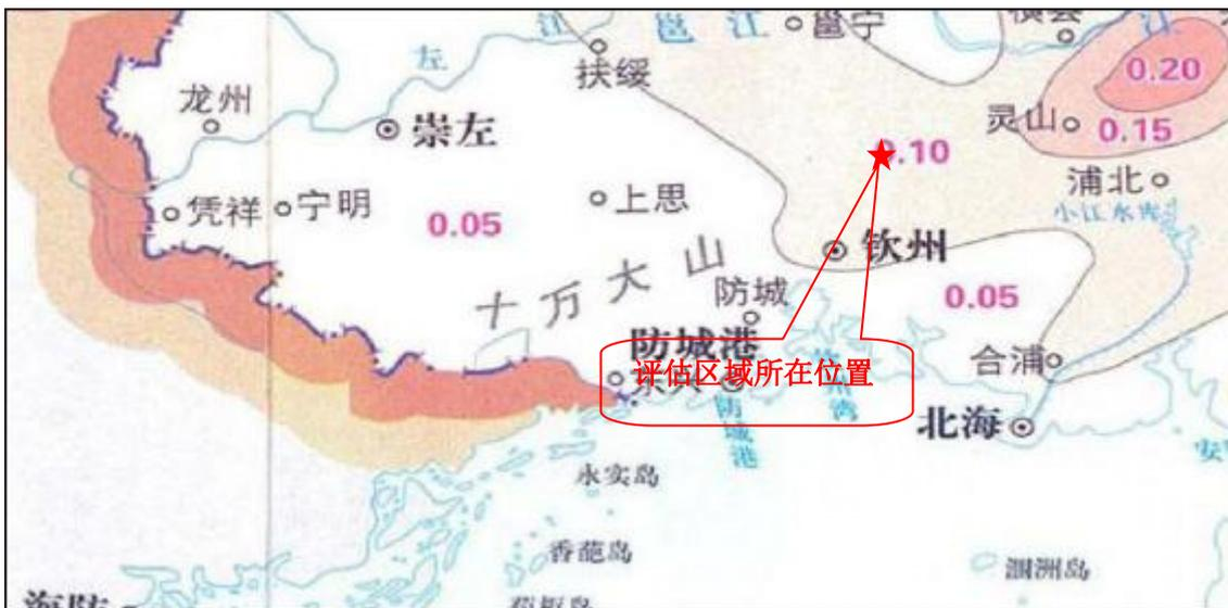
图 3.1-3 中国地震动峰加速度区划图
