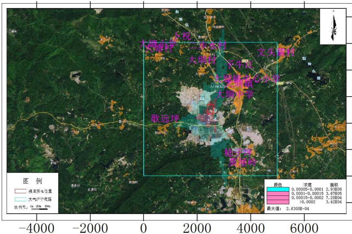
图 4.2-17 PM<sub>2.5</sub> 年平均质量浓度贡献值分布图 (单位  $\mu\text{g}/\text{m}^3$ )
