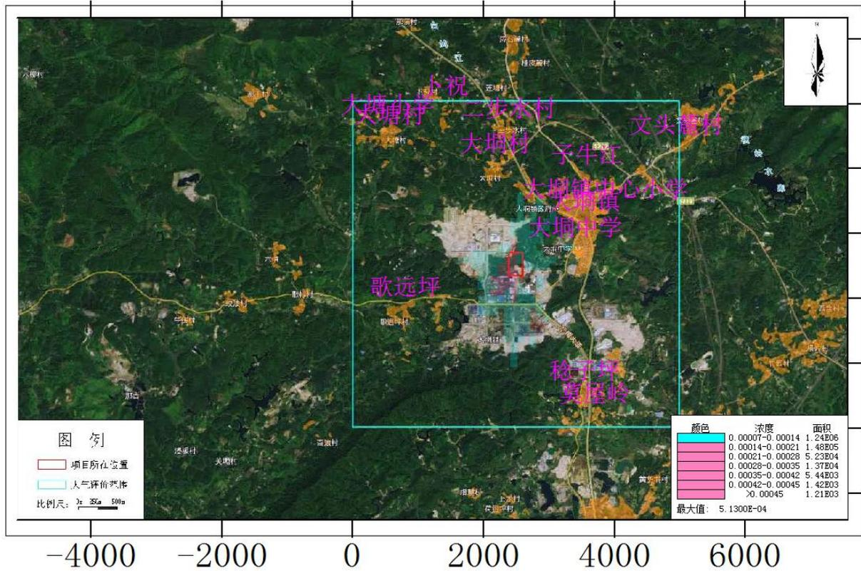
图 4.2-19 氨 1 小时质量浓度贡献值分布图 (单位:  $\mu\text{g}/\text{m}^3$ )
