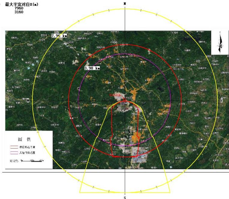
图 4.9-10 最不利气象条件下精硫储槽泄露达不同毒性终点浓度的最大影响范围图
