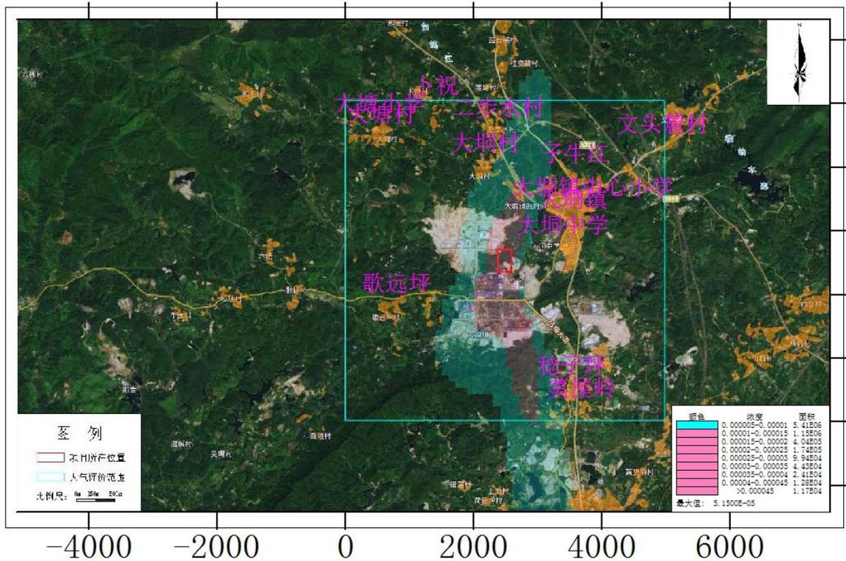
图 4.2-18 锰及其化合物日平均质量浓度贡献值分布图（单位： $\mu\text{g}/\text{m}^3$ ）
