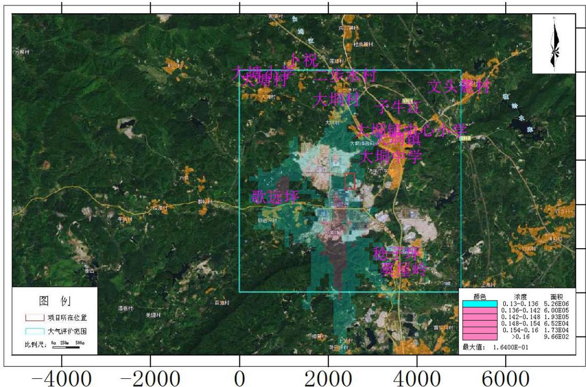
图 4.2-25 TSP 叠加现状日平均质量浓度分布图 (单位  $\mu\text{g}/\text{m}^3$ )
