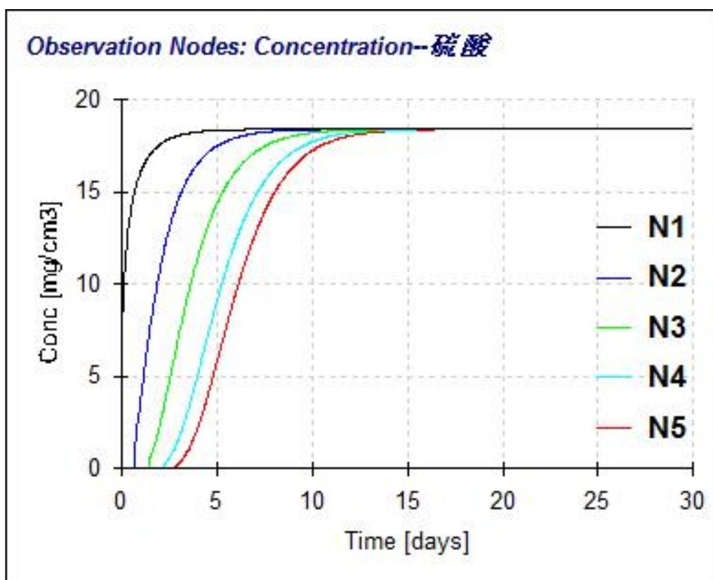
图 4.7-2 各观测点 SO<sub>4</sub><sup>2-</sup>时间-浓度图
